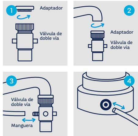
4. Una vez instalado el adaptador y la válvula en su grifo, proceda a **conectar la manguera a la válvula (Fig. 3)**.
