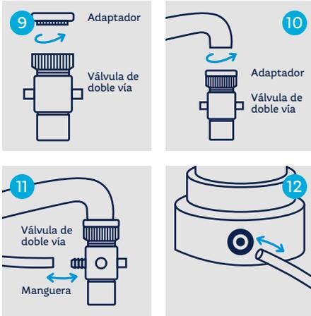
2. Si ud posee un grifo sin rosca, **coloque primero el adaptador de goma** para tal fin en su grifo. Este adaptador **se coloca a presión hacia arriba**, luego **se ajusta con una abrazadera** para que quede firme.
